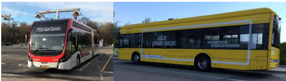
Figur 3-5 Snabbbladdade batteribussar. T.v. 18m ledbuss i Eindhoven. Konduktiv laddning. Tillverkare VDL/Heliox. T.h. 12m standardbuss i Berlin. Induktiv laddning. Tillverkare Solaris/Bombardier. Foto: Hannes Englessen.
