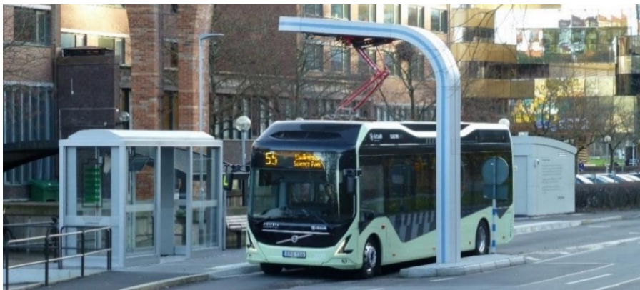
Figur 3-4 Tilläggsaddad batteribuss som snabbbladdas vid ändhållplats på linje 55 i Göteborg. Foto: PG Andersson
