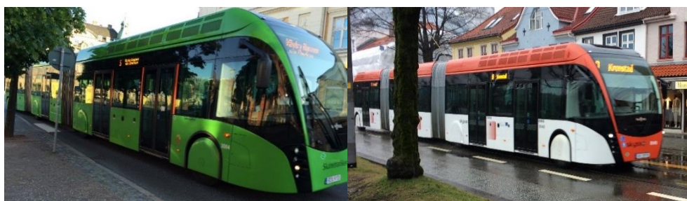
Figur 3-2 24-meters gashybridbussar rullar idag i Malmö (t.v.) och Bergen (t.h.). Tillverkare Van Hool. Foto: Hannes Englesson.
