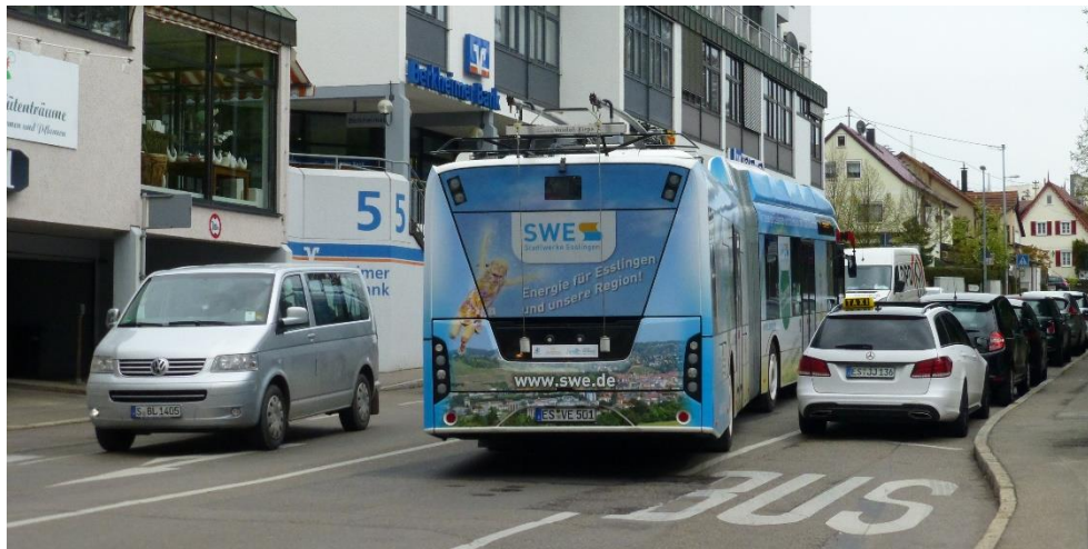
Figur 3-7 IMC-buss i Esslingen med nedfällna trolleysträngar och körning på batteri. Foto: PG Andersson
