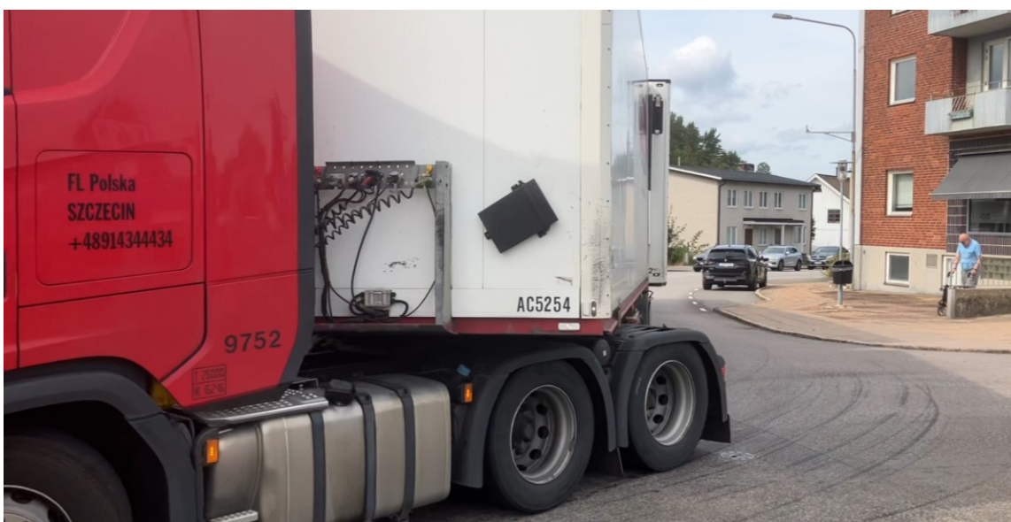
Utfart från Hinnerydsvägen till Lagastigsgatan. I stort sett samtliga långtradare behöver använda båda filerna, ändå kör släpets bakaxel upp på gångbanan.
