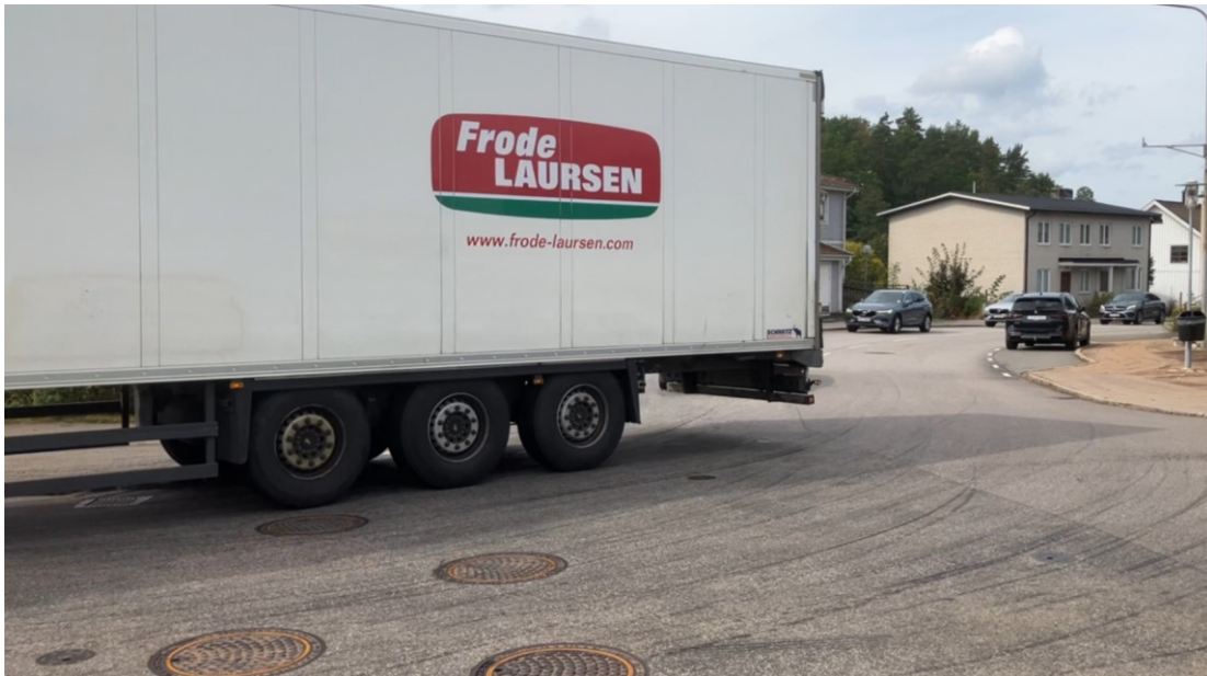
Notera hur släpets bakaxel kör upp på gångbanan.
